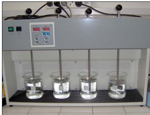
Εικόνα 2. Συσκευή κροκίδωσης (Jar test)
